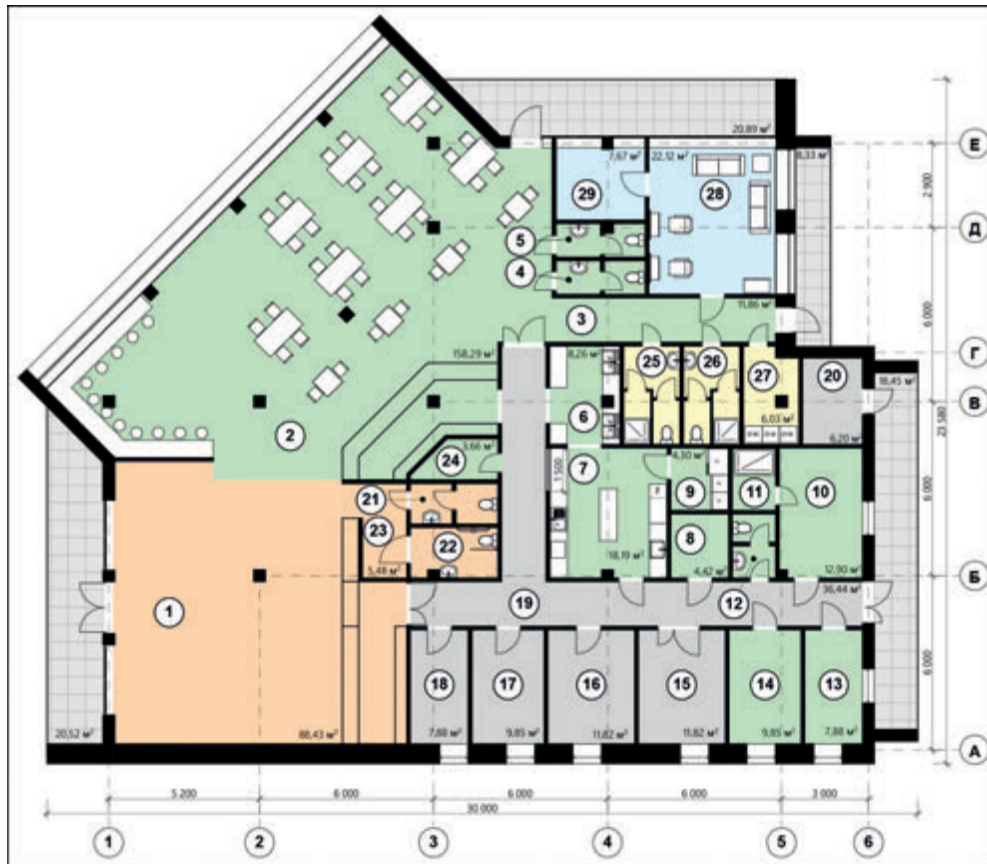
Рис.3. План будівлі АЗК
